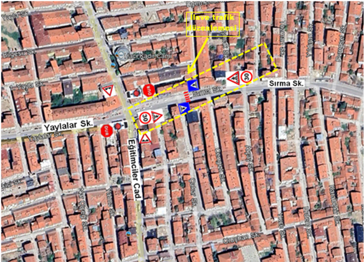
Şekil 4. Tepebaşı ilçesi Sütlüce Mah. Marmaralı Sk.-Uluzafar Cad. kesişimi ve Eğitimciler Cad.-Yaylalar Sk. - Sırma Sk. Kesişimi mevcut ve ilave trafik düzenlemesi
